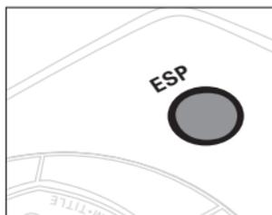
Cuando Vd. enciende su reproductor, la función ESP aparece visualizada y queda automáticamente activada.
