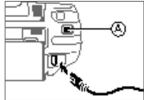
Ak je prístroj pripojený k sieti, napájanie z článkov bude prerušené. Ak vytiahnete zástrčku sieťového prívodu zo vstupu AC MAINS, prístroj bude znovu napájaný z článkov.
