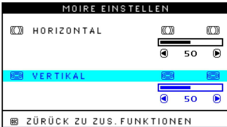
7) Zur Einstellung des vertikalen Moirés, drücken Sie den ◀ oder den ▶ Schalter.
