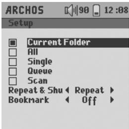
**Kontrollfelder:** Die einzelnen Kontrollfelder entsprechen den verschiedenen Parametern, es kann jedoch immer nur ein Wert gleichzeitig ausgewählt werden. Drücken Sie die Taste AUF bzw. AB, bis das gewünschte Element hervorgehoben ist. Bestätigen Sie Ihre Auswahl mit der Taste OK. Nach Abschluss der Einstellungen die Taste Abbrechen drücken.
