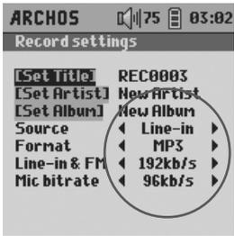
**Zur Auswahl stehende Elemente:** Zum Ändern eines Einstellwertes die Taste LINKS bzw. RECHTS drücken. Der neue Wert wird sofort berücksichtigt, es ist nicht erforderlich, mit OK zu bestätigen. Nach Abschluss der Einstellungen die Taste Abbrechen drücken.
