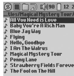
Drücken Sie die Taste AUF bzw. AB, bis das gewünschte Element hervorgehoben ist. Durch Gedrückthalten der Taste scrollt die Liste weiter nach oben/unten zu den weiteren Elementen. Die Scroll-Anzeige rechts weist auf die relative Position in der gesamten Liste hin.
