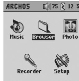
Die Bildsymbole entsprechen den verschiedenen Modi. Mit den Tasten LINKS, RECHTS, AUF und AB können Sie zwischen den einzelnen Symbolen wechseln. Zur Auswahl eines Bildsymbols die Taste OK drücken, die entsprechende Funktion wird aufgerufen. Um einen Vorgang zu beenden, die Taste Abbrechen drücken.
