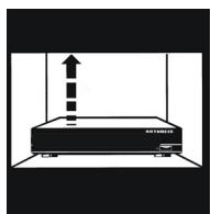
Bien que l'évacuation de la chaleur produite dans le modem soit suffisamment garantie, n'installez jamais le modem dans une armoire ou sur une étagère s'il n'y dispose pas d'une ventilation suffisante. L'espace libre au-dessus du modem devrait être au moins de 5 cm. N'obstruez jamais les ouvertures de ventilation de l'appareil.
