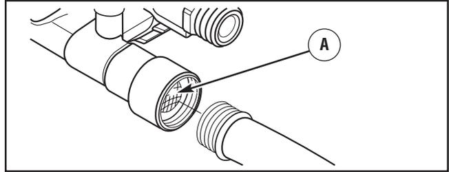
5. Connectez le tuyau d'arrosage (ne pas dépasser 50 pieds dans la longueur) à la prise d'eau. Serrez manuellement.
