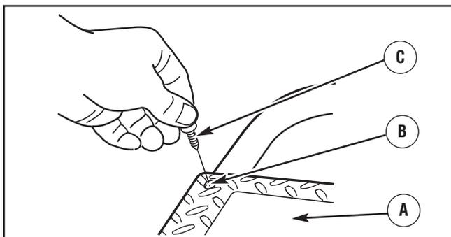
4. Insérez le moule en broche du support de pistolet de pulvérisation (A) par le trou situé du côté gauche de la poignée (en regardant de l'avant de l'appareil). Maintenez le moule en broche et fixez un bouton en plastique (B) à partir de l'intérieur de l'unité. Serrez à la main.
