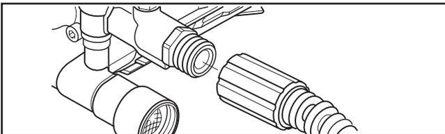
3. Faites couler de l'eau dans le tuyau d'arrosage pendant 30 secondes pour nettoyer tous les débris. Fermez le robinet d'eau.
