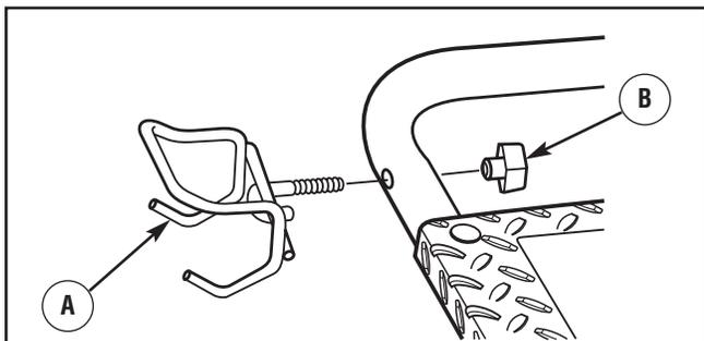
5. Insérez l'autre crochet en "L" (A) par le trou situé directement en dessous du panneau d'affichage, du côté droit de la poignée (en regardant de l'avant de l'appareil). Maintenez le crochet et fixez un bouton en plastique (B) depuis l'intérieur de l'unité. Serrez à la main.
