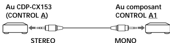
Veillez à raccorder la minifiche STEREO au composant CONTROL A et la minifiche MONO au composant CONTROL A1.
