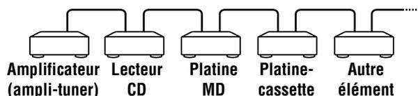
Dans le système de commande CONTROL A1II, les signaux de commande vont dans les deux sens (les mêmes prises servent à l'entrée et à la sortie des signaux). Si un élément comporte plusieurs prises CONTROL A1II, vous pouvez utiliser n'importe laquelle et raccorder des éléments différents à chaque prise.
