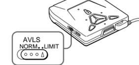
側面のAVLSスイッチを「LIMIT」にする。音量を調節しても、一定のレベル以上大きくなりません。
