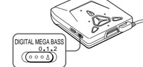
側面のDIGITAL MEGA BASSスイッチをずらす。「1(弱)」「2(強)」2段階のメガベース効果が働きます。
