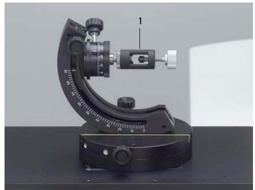
Fig. 45 Support amovible avec logement pour cylindre de fermeture
