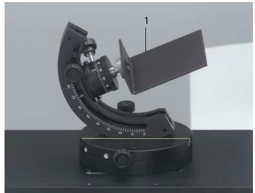
Abb. 45 Verstellbarer Halter mit Aufnahme für Schließzylinder
