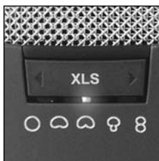
Fig. 1: comutador de seleção para características direcionais
