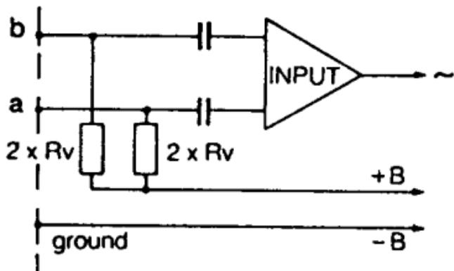
Si las entradas de los amplificadores están puestas a tierra o no tienen transformadores de entrada deben incorporarse condensadores o transformadores adicionales en las líneas de baja frecuencia para evitar que las corrientes de pérdida obstaculicen la etapa de entrada.
