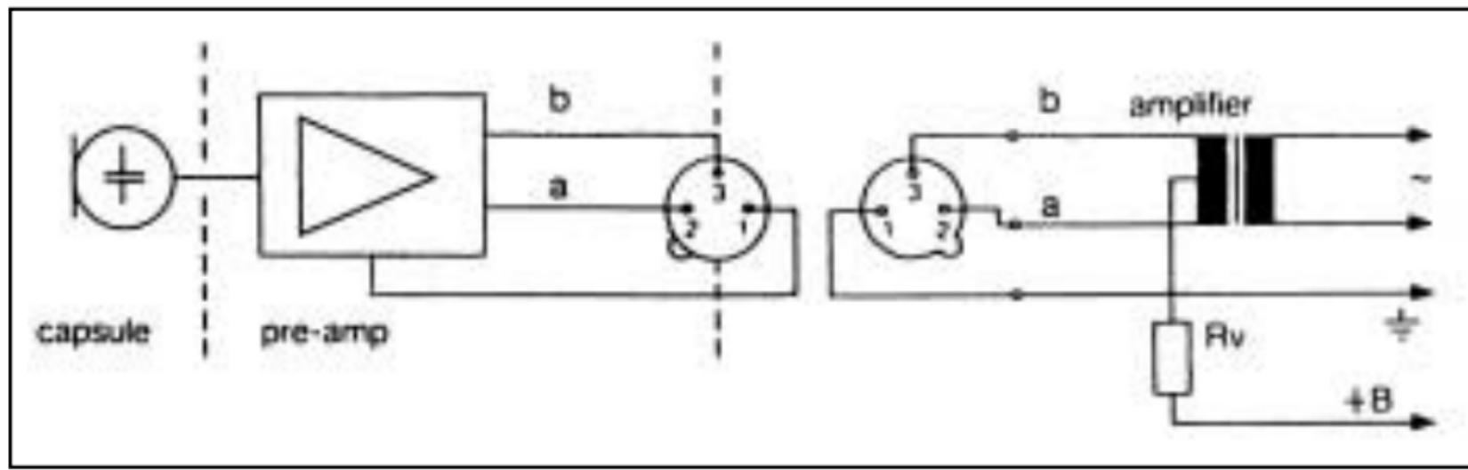
b) collegamento con trasformatore d'ingresso **senza**
