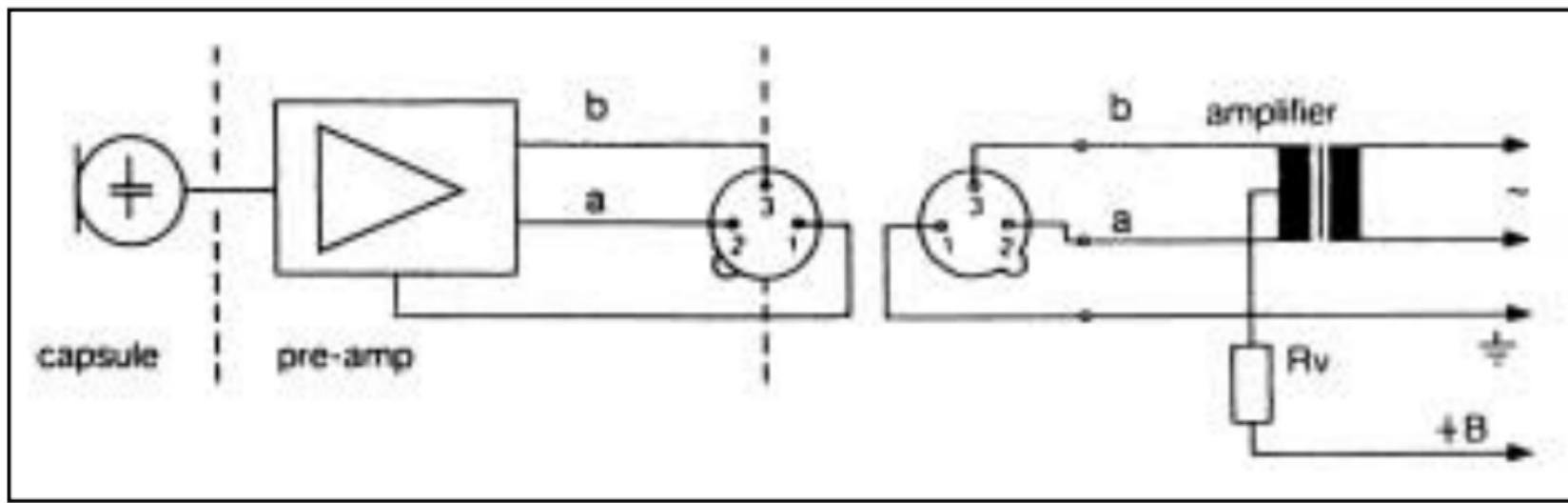
b) Conexión con transformador de entrada **sin** toma central (sin toma de tierra).
