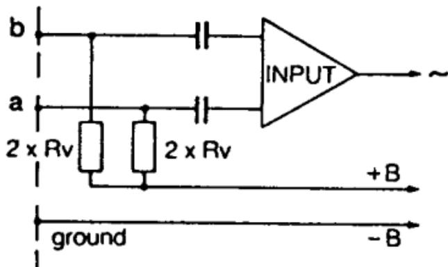
Se gli ingressi dell'amplificatore sono collegati a terra o se non esiste una trasformazione d'ingresso, bisogna inserire condensatori o trasformatori addizionali nelle linee a bassa frequenza, per impedire che lo stadio d'ingresso venga perturbato da correnti di dispersione.
