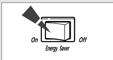
**Si desea ahorrar la energía para el uso de su aire acondicionado, puede seleccionar el modo de ahorro para energía usando el interruptor de Ahorro de Energía. Normalmente se usa cuando la habitación está deshabitada.**
