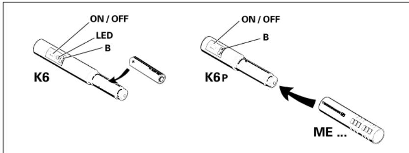
Mit den Speiseadapters K6 und K6P werden die aufschraubbaren Mikrofonmodule des System K6 mit Strom versorgt und an die nachfolgenden Verstärker angepaßt. Der Speiseadapter dient auch als Griffstück. Über die vielfältigen Kombinationsmöglichkeiten des Systems K6 informiert die beiliegende Systemübersicht.
