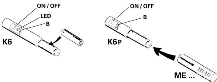
Con gli adattatori di alimentazione K6 e K6P i moduli avvitabili del microfono del sistema K6 vengono alimentati con corrente e adattati ai successivi amplificatori. L'adattore di alimentazione svolge anche la funzione di pezzo di impugnatura. L'acclusa panoramica del sistema informa sulle molteplici possibilità di combinazione del sistema K6.
