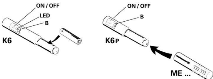
Met behulp van de netadapters K6 en K6P worden de opschroefbare microfoonmodulen van het systeem K6 met stroom verzorgd en aangepast aan de navolgende versterker. De netadapter dient ook als handgreep. Het bijgesloten systeemoverzicht biedt informatie over de veelvoudige combinatiemogelijkheden van het systeem K6.
