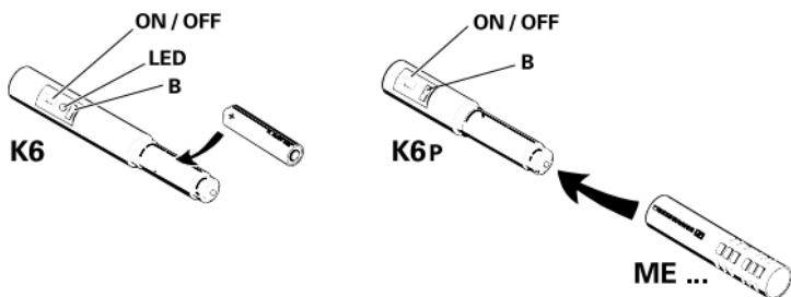
Les corps de micros/alimentation K6 et K6P servent à alimenter les têtes de microphone du système K6. Ils comprennent une sortie symétrique sans transformateur. La page ci-jointe montre les combinaisons possibles du système K6/K6P.
