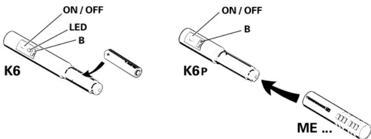
Los adaptadores K6 y K6P alimentan los módulos micrófono a atornillar del sistema K6 y los adaptan a los amplificadores siguientes y además sirven como empuñadura. La vista general del sistema añadida da informaciones detalladas sobre los multibles posibilidades de combinación.
