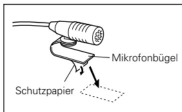
**2** Richten Sie das Mikrofon waagerecht so aus, dass es in Richtung Fahrer zeigt.
