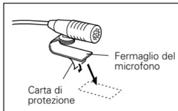
**2** Regolare l'orientamento orizzontale del microfono in modo tale che sia rivolto verso il conducente.
