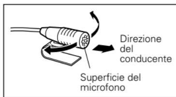
**3** Posizionamento del cavo del microfono.
