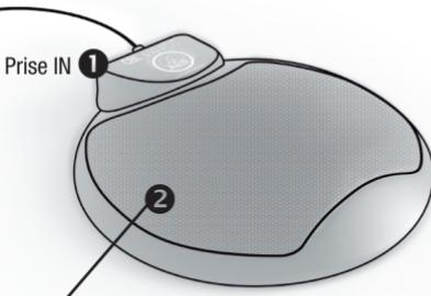
① Grille de sécurité: ne pas recouvrir la grille avec quelque objet que ce soit (papiers, etc.)!
