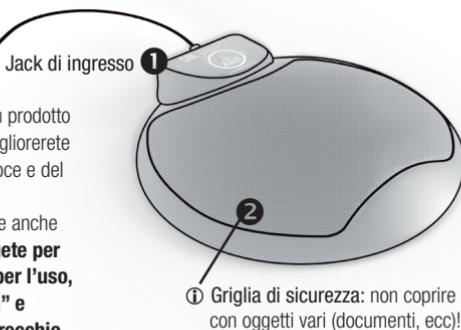
Procedete come descritto nel punto "Applicazione singola" e inserite il secondo CBL 410 PCC nel jack di ingresso ① del primo microfono, se necessario, un terzo al secondo e così via. Si possono connettere in cascata in questo modo fino a quattro CBL 410 PCC. A partire da 5 elementi la qualità del suono deteriora in modo significativo, perché il vostro PC dispone di una tensione di alimentazione limitata.
