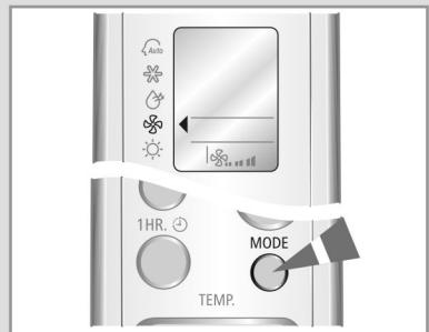
**3 Odaberite brzinu ventilatora pritiskom na tipku
