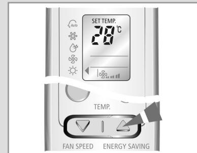
4 Odaberite brzinu ventilatora pritiskom na tipku
