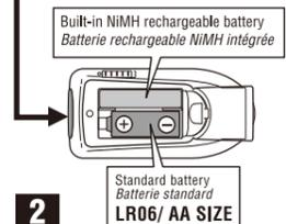
**Important** (before using the product) / **Chargement de la batterie** (avant d'utiliser le produit)
