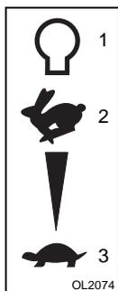
La manette des gaz permet de régler le régime du moteur et de fermer le volet de départ pour la mise en marche.
