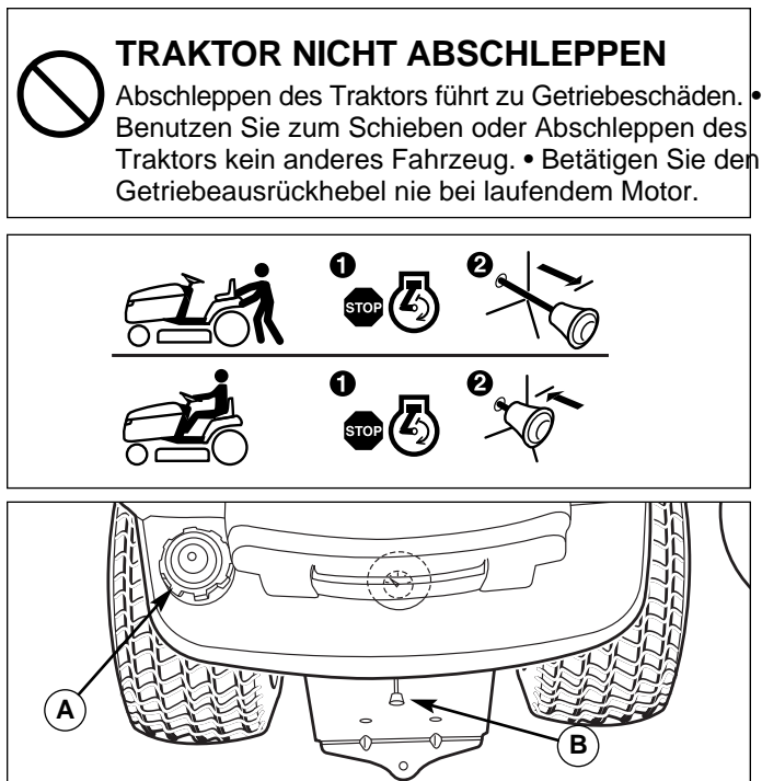
Abb. 4. Getriebeausrückhebel und Kraftstofftank
