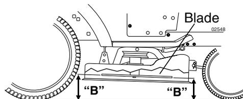
**BOTH FRONT PLATE LINKS MUST BE EQUAL IN LENGTH**
