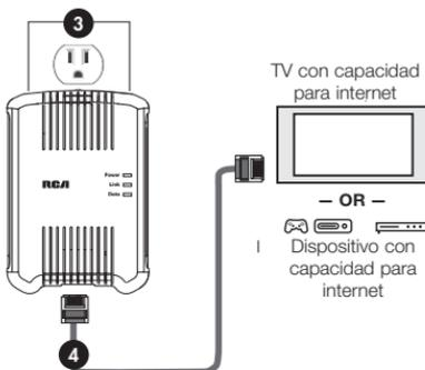
3. Conecte la otra unidad HDP50 en una toma eléctrica cerca de su TV u otro dispositivo de entretenimiento para el hogar que tenga capacidad para internet. El indicador **Power** al frente del adaptador se ilumina.
