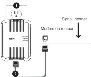
1. Branchez un des adaptateurs HDP50 dans une prise électrique à proximité de votre modem. L'indicateur **Power** situé à l'avant de l'adaptateur s'allume.
