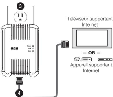
3. Branchez l'autre adaptateur HDP50 dans une prise électrique près de votre téléviseur ou autre appareil de divertissement supportant la réception par Internet. L'indicateur **Power** situé à l'avant de l'adaptateur s'allume.
