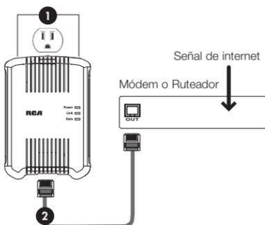
1. Conecte una de las unidades HDP50 a una toma de corriente eléctrica cerca de su módem. El indicador **Power** al frente del adaptador se ilumina.
