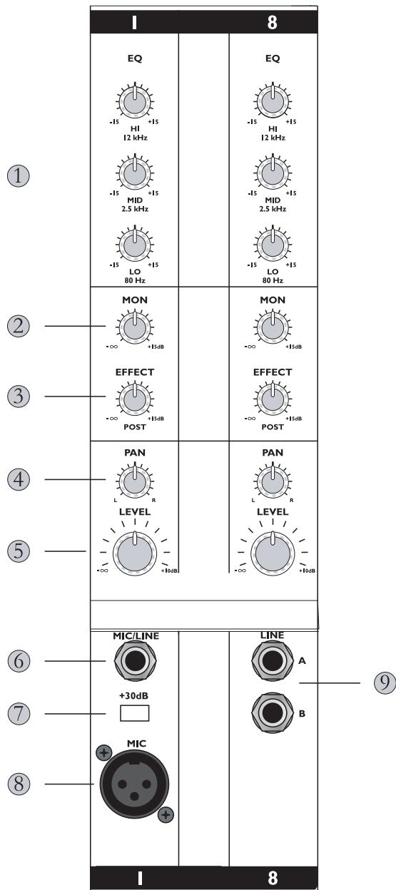
1. I **comandi dell'equalizzatore** vi permettono di modellare il suono del canale prima che sia inviato alle uscite.
