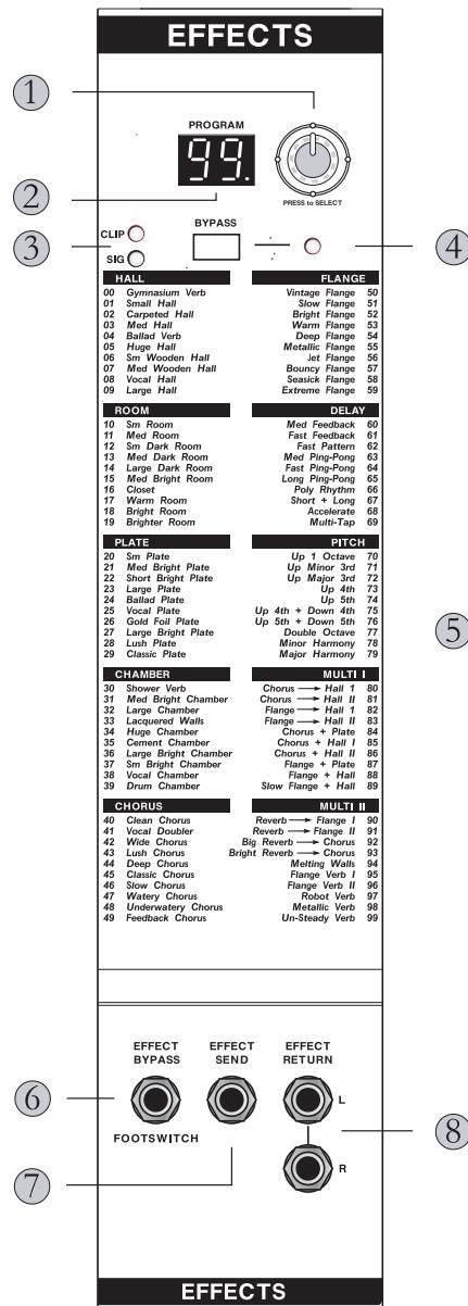
1. Zur **Auswahl** des gewünschten Effektprogramms verwenden Sie den Programmauswahlschalter. Drücken Sie diesen, um ein neues Programm abzurufen.
