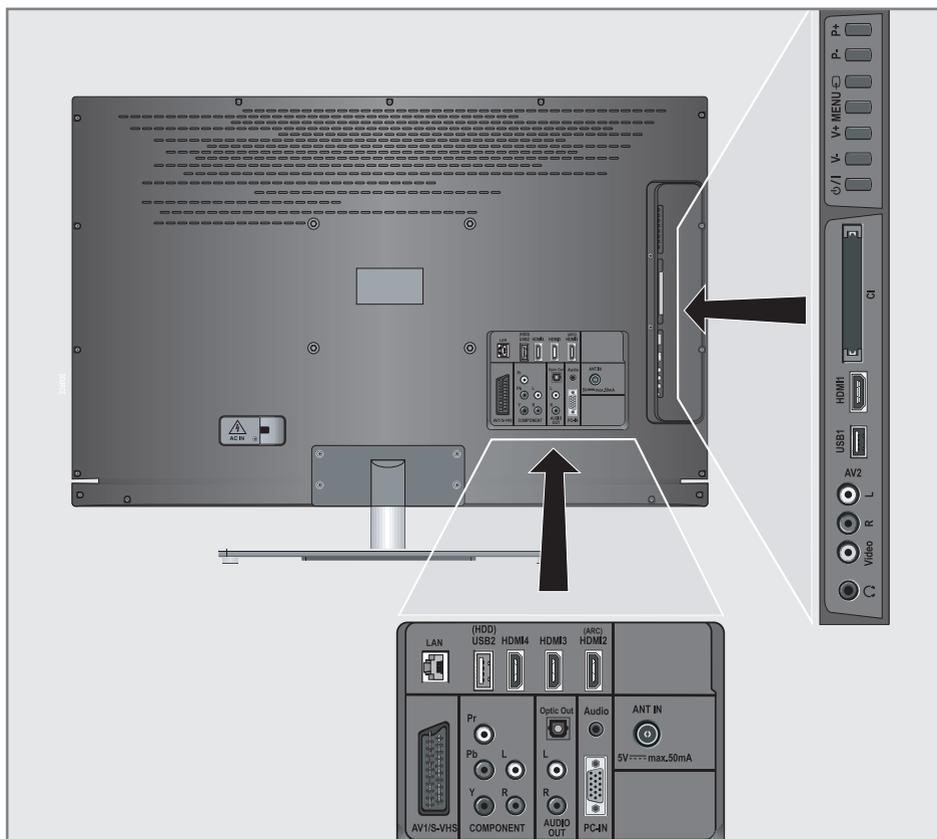
**AV1 / S-VHS** SCART-kontakt (CVBS-signal, RGB-signal); Video- og lydkontakt for S-Video-videokamera.
