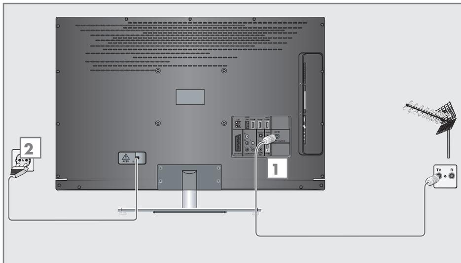
**1a** For å motta vanlige digitale sendere (DVB-T) koble kabelen for takantennen eller den innendørs antennen (passiv eller aktiv innendørs antenne med egen strømforsyning) til antennekontakten »ANT IN« på TV-apparatet;
