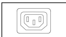
**Cordón de alimentación de entrada de CA secundaria (Modelo PDUMH15AT):** La entrada IEC-320-C14 se conecta al cordón de alimentación de entrada de CA secundaria separable.
