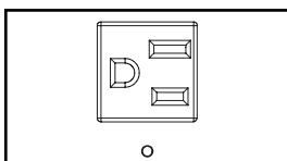
**Salidas NEMA 5-15R (Modelo PDUMH15AT):** Durante la operación normal, las salidas distribuyen la energía de CA al equipo conectado. Cuando hay energía en la salida, el LED correspondiente se encenderá.
