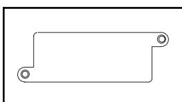
**Ranura auxiliar:** Una tarjeta SNMP opcional podrá ser instalada en la ranura, permitiendo la configuración, el control y el monitoreo remoto de la PDU. Contacte con el Soporte al cliente de Tripp Lite al (773) 869-1234 para mayor información.
