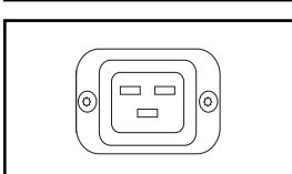
**Cordon d'alimentation d'entrée secondaire CA (Modèle PDUMH20AT)** : Le cordon d'alimentation d'entrée secondaire CA amovible se connecte à l'embase IEC-320-C20.
