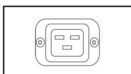
**Cordón de alimentación de entrada de CA secundaria (Modelo PDUMH20AT):** La entrada IEC-320-C20 se conecta al cordón de alimentación de entrada de CA secundaria separable.
