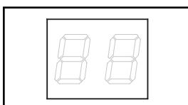
**Medidor digital de carga (Amperímetro):** La corriente eléctrica total usada por la unidad de distribución de potencia (PDU) será mostrada en el medidor digital, en amperios.
