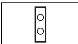
**Indicador de fuente de entrada:** Al conectar la PDU a una fuente de energía de CA, el LED de entrada primaria o secundaria se encenderá para indicar cuál de las fuentes suministra energía a las salidas de la PDU.
