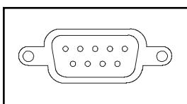
**Puerto DB9:** Este puerto está reservado para la configuración, la cual deberá realizar solamente el personal autorizado por la fábrica. No conecte nada al puerto. Contacte con el Soporte al cliente de Tripp Lite al (773) 869-1234 para mayor información sobre las opciones para ampliar la funcionalidad de la PDU.
