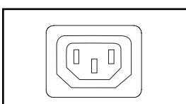
**Cordon d'alimentation d'entrée secondaire CA (Modèle PDUMH15AT)** : Le cordon d'alimentation d'entrée secondaire CA amovible se connecte à l'embase IEC-320-C14.
