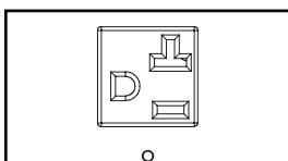
**Salidas NEMA 5-15/20R (Modelo PDUMH20AT):** Durante la operación normal, las salidas distribuyen energía de CA al equipo conectado. Cuando hay energía en la salida, el LED correspondiente se encenderá.
