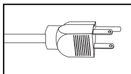
**Cordón de alimentación de entrada de CA primaria (Modelo PDUMH15AT):** Este cordón se encuentra conectado permanentemente a la PDU y tiene un enchufe NEMA 5-15P.
