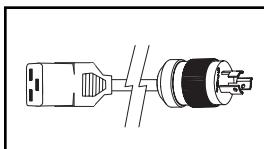
**Cordón de alimentación de entrada de CA secundaria (Modelo PDUMH20AT):** El cordón separable tiene un conector IEC-320-C19 y un enchufe NEMA L5-20P.
