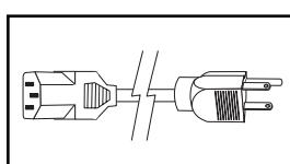
**Cordón de alimentación de entrada de CA secundaria (Modelo PDUMH15AT):** El cordón separable tiene un conector IEC-320-C13 y un enchufe NEMA 5-15P.
