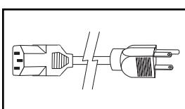
**Cordon d'alimentation d'entrée secondaire CA (Modèle PDUMH15AT)** : Le cordon amovible dispose d'un connecteur IEC-320-C13 et d'une fiche NEMA 5-15P.
