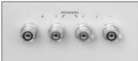
Abb. 2 Lautsprecherklemmen am Verstärker (Beispiel).
