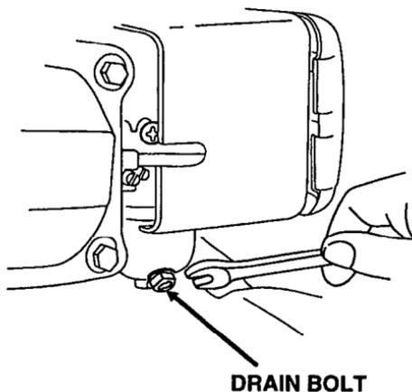
3. Reinstall the drain bolt.
