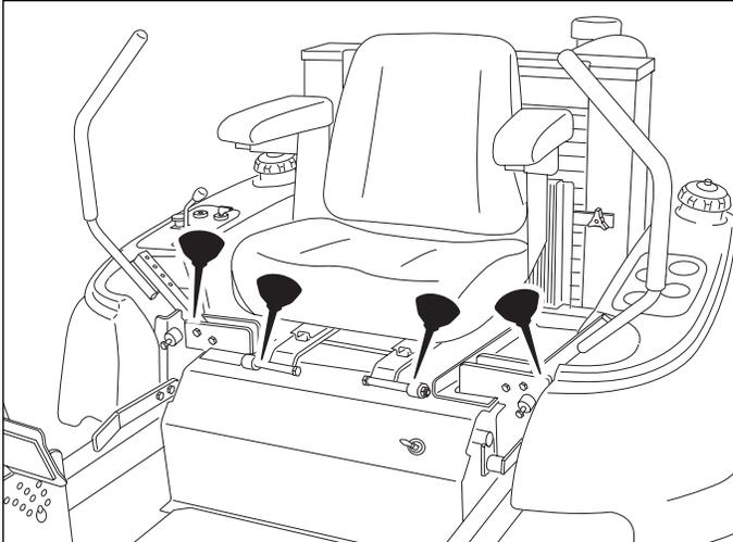
**Figure 26. Control Handle Pivots & Seat Pivots**
