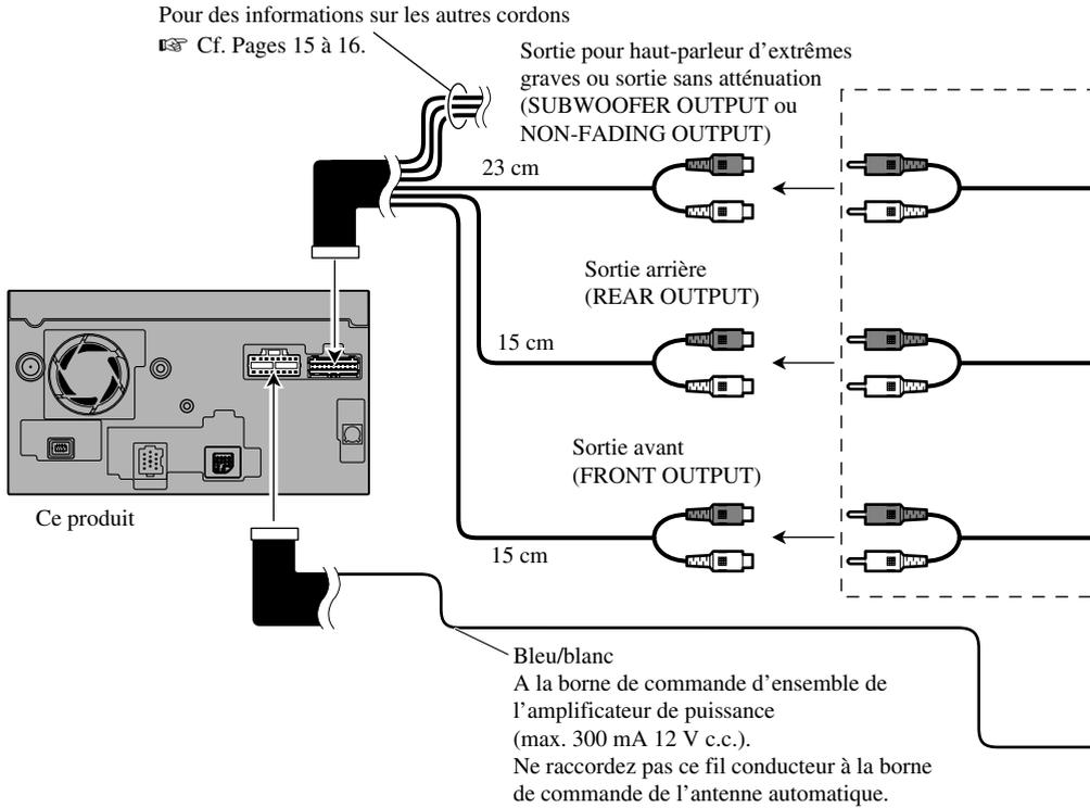
Effectuez ces connexions si l'amplificateur en option est utilisé.
