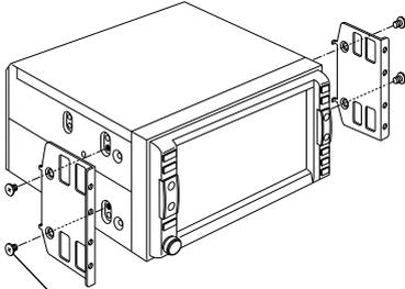
Vis de fixation de support latéral (5 × 6 mm)
