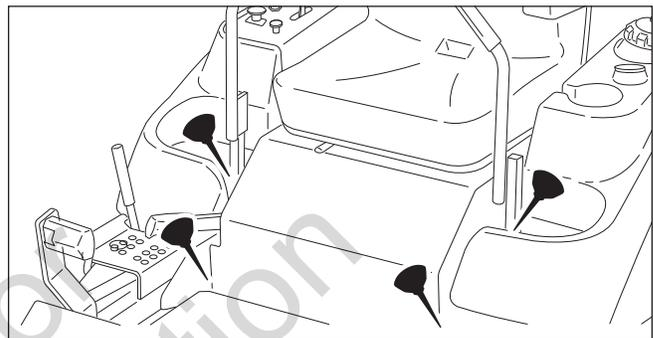
Figure 21. Control Handle Pivots & Seat Plate Pivots
