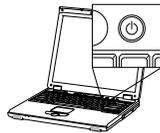
El pulsador de DC en/prende lejos el sistema no apaga el poder de sistema AC. Para quitar AC el poder del sistema, usted debe quitar cada cuerda del poder de AC de la salida de pared o alimentación.
