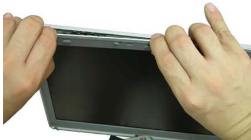
Fig. 23 Removing the LCD Bezel
