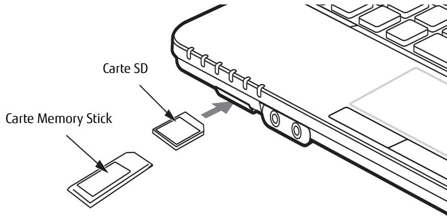
**Figure 26. Installation d'une carte Memory Stick ou SD**
