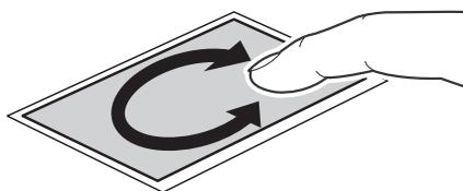
Figure 17. Défilement continu à l'aide du pavé tactile
