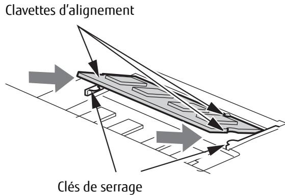
Figure 29. Installer un module de mémoire
