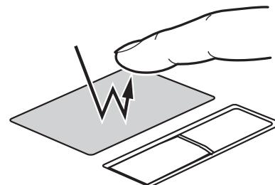
Figure 12. Double-cliquer à l'aide du pavé TouchPad
