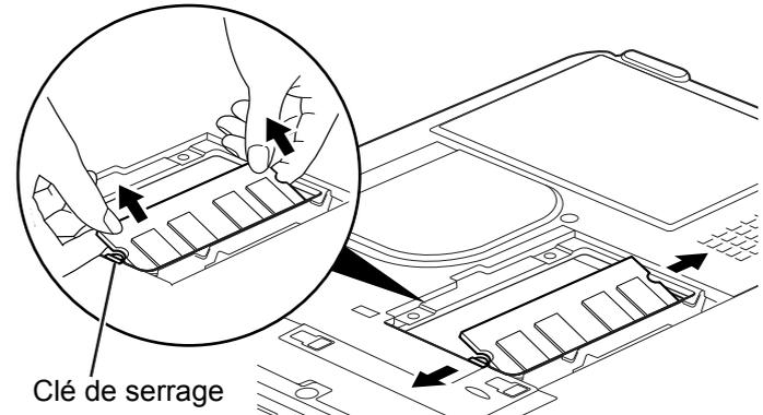
**Figure 40. Installation d'un second module de mémoire**
