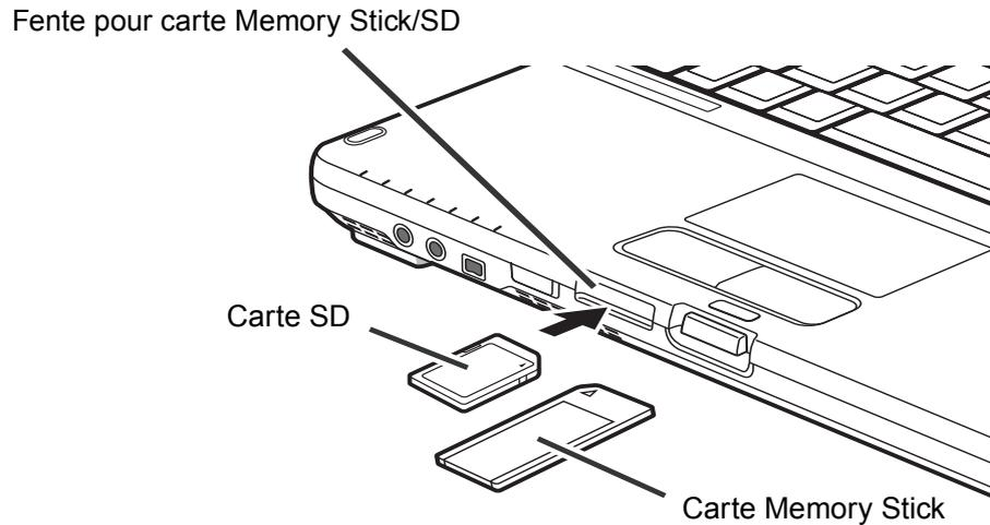
**Figure 37. Installation d'une carte Memory Stick ou SD**
