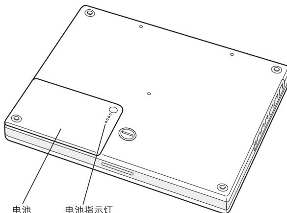
如果 Finder 菜单中电池图标已被设定为显示电量百分比，则有时您会注意到在电脑接上电源适配器时，电池不会保持 100% 的满电量状态。当电池电量最终降到 95% 以下时，电池会一直充电到 100%。这会延长电池的寿命，因为充电不会连续时续时断。
