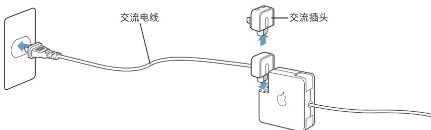
**【警告】** 请确定将电源适配器插入电源插座之前，适配器已完全组装好。如果您要将交流插头和电源适配器配合使用，请确定两个插销已完全插入凹口中（这时插头和适配器成为完美的一体），然后再将适配器插在插座上。
