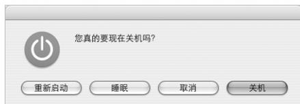
**【警告】** 必须等几秒钟直到位于显示屏锁扣旁边的白色睡眠指示灯开始闪亮（表示电脑处于睡眠状态，硬盘已停止转动）后才能移动 iBook G4。硬盘转动时移动电脑会损坏硬盘，导致数据丢失或者不能从硬盘启动。
