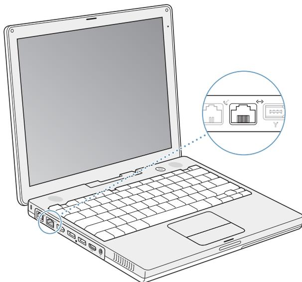
连接到网络后您就可以访问其他电脑。您就可以存储和取回信息；使用网络打印机、调制解调器和电子邮件；或接入 Internet。您可以使用以太网在两台电脑之间共享文件或建立小型网络。您也可以将线缆调制解调器和 DSL 调制解调器连接到以太网端口以通过 Internet 服务提供商 (ISP) 来访问 Internet。iBook G4 上的以太网端口会自动检测其他以太网设备。当连接到其他以太网设备时不必使用以太网交叉电缆。
