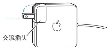
**【重要事项】** 务必将交流插头上的两个插销完全插入凹口中（这时插头和适配器成为完美的一体），然后再将适配器插在插座上。
