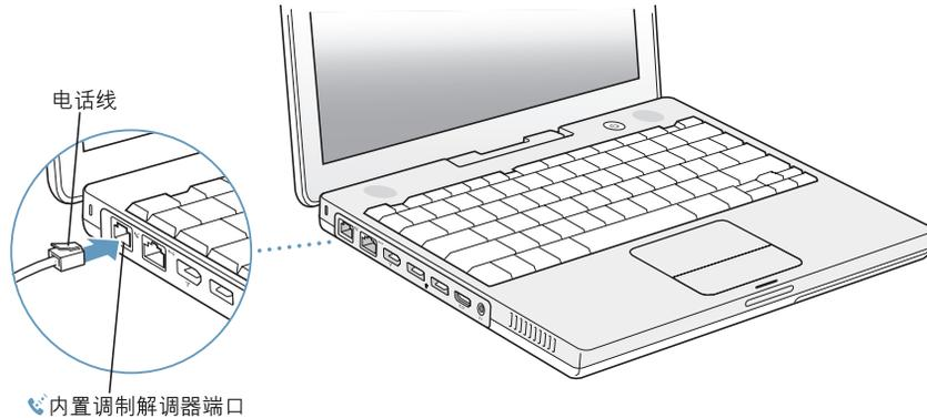
一定要将内置调制解调器连接到模拟电话线路上（家庭通常使用的那种）。该调制解调器不能配合数字电话线路使用。
