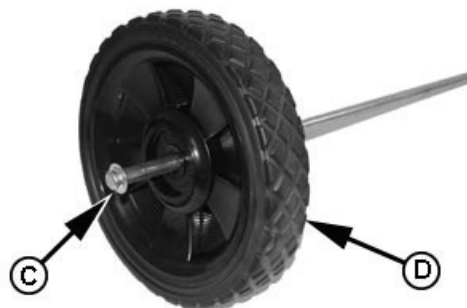
Installation de la roue sur l'essieu
