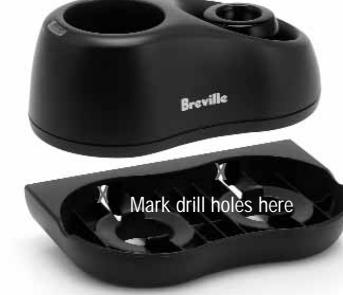
3. Percez un trou de 5 mm (0,2 po) de diamètre au centre de chacune des marques. Insérez un ancrage en plastique dans chacun des trous.
