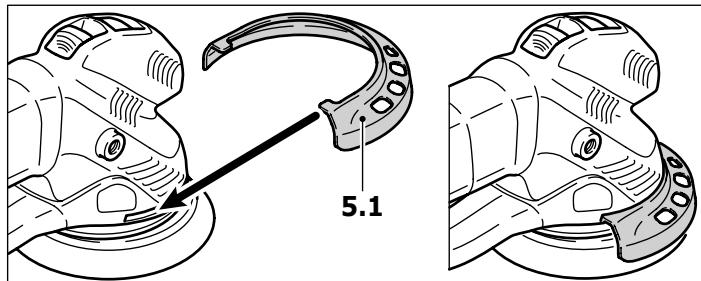
Montaje: empuje la protección de cantos hasta que encaje en la máquina (véase la imagen 5).
