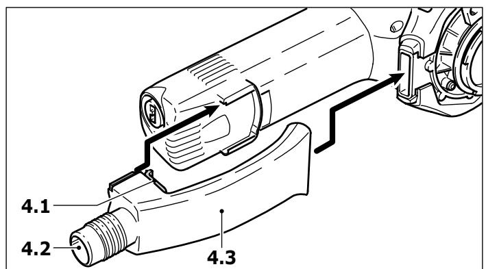
Cuando sea necesario, puede extraer el adaptador de aspiración (4.3). Para hacerlo, pulse la tecla de cierre (4.1) y tire del adaptador de aspiración hacia atrás.
