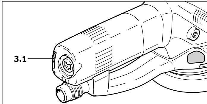
Le régime est réglé en continu au moyen de la molette (3.1) entre 3300 et 6800 tr/min. Vous pouvez ainsi adapter de façon optimale la vitesse de coupe à chaque matériau.
