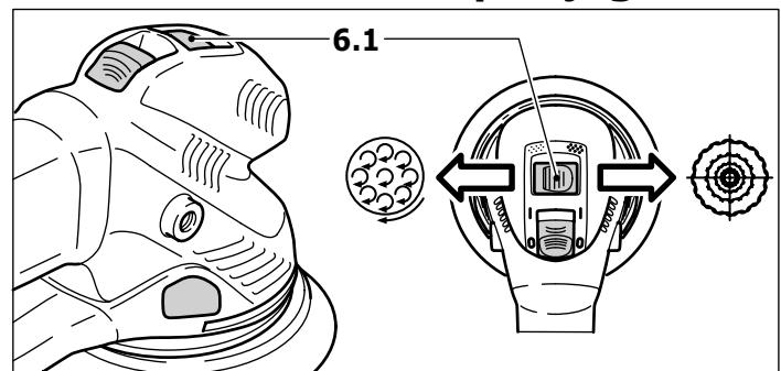
Le commutateur (6.1) permet de régler deux mouvements de ponçage différents.
