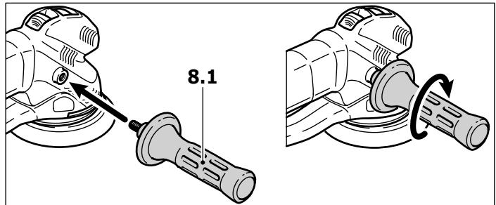
El mango adicional (accesorios, 8.1) puede fijarse según se desee a la derecha o la izquierda en la cabeza del engranaje.
