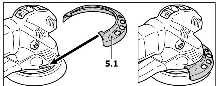
La protection des arêtes (5.1) évite que les bords du plateau de ponçage n'entrent en contact avec une surface quelconque (par exemple lors du ponçage le long d'un mur), ce qui empêche également tout rebond éventuel de l'outil.
