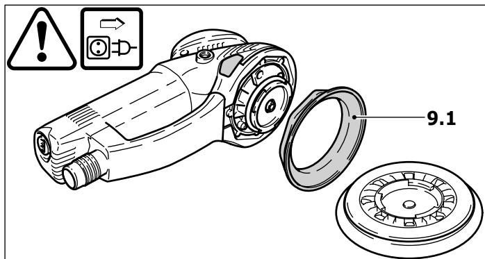
El manguito de goma (9.1) impide que el plato lijador se acelere descontroladamente durante el movimiento excéntrico (lijado fino). Debido a que esta guarnición se desgasta con el tiempo, ésta tiene que ser renovada cuando se registre una merma en el efecto de frenado (núm. de pedido 465472).
