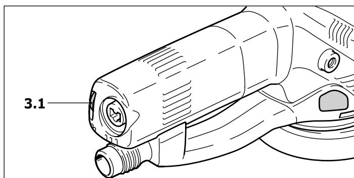
Las revoluciones pueden regularse de modo continuo con la rueda de ajuste (3.1) entre 3300 y 6800 r.p.m.. Esto le permite optimizar la velocidad
