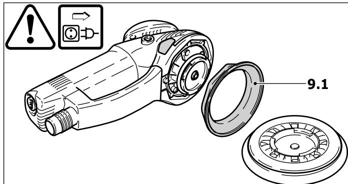
Le manchon en caoutchouc (9.1) permet, lors du mouvement excentrique (ponçage fin), de limiter la vitesse du patin de ponçage. La collerette étant soumise à l'usure dans le temps, l'effet de blocage s'affaiblit, et elle doit être remplacée par une neuve (référence 465472).
