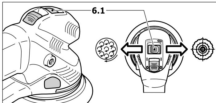
Con el interruptor (6.1) pueden ajustarse dos movimientos de lijado diferentes.
