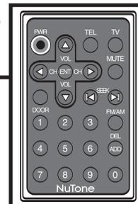
La télécommande est fournie avec une pile disque (CR2025) qui doit être installée pour pouvoir utiliser la télécommande.
