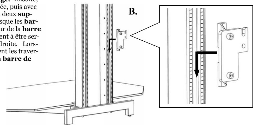
**REMARQUE :** Ne pas oublier de vérifier que le **support de tablette** est installé avec le trou à encoche sur le dessus et tourné vers l'extérieur.
