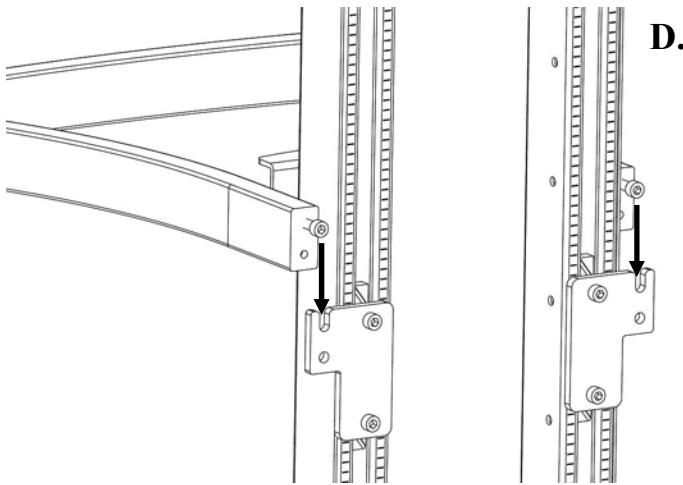
B. Deslice ambos **sujetadores de abrazadera del estante** en el **poste de montaje**. Luego deslícelos hasta la posición deseada y con la **Llave hexagonal** suministrada, ajuste ambos **sujetadores de abrazadera del estante**. (Las **barras en forma de T del estante** girarán hacia la derecha una vez dentro del **poste de montaje** y usted comenzará a apretar los **tornillos**. Una vez ajustados, agarrarán las guías internas del **canal del poste de montaje**).
