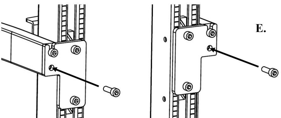
C. Eine **Regalschraube** in jede obere Bohrung des Regals einsetzen.
