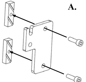
B. Beide **Regalhalterungen** in die **Montagestange** schieben. Die Halterungen anschließend in die gewünschte Stellung bringen und beide **Regalhalterungen** mit dem im Lieferumfang enthaltenen **Sechskantschlüssel** festziehen. (Die Regal-T-Stahlleisten drehen sich nach rechts, sobald sie sich in der Montagestange befinden und die Schrauben festgezogen werden. Beim Festziehen greifen sie in die inneren Schienen der **Montagestangenführung** ein.)
