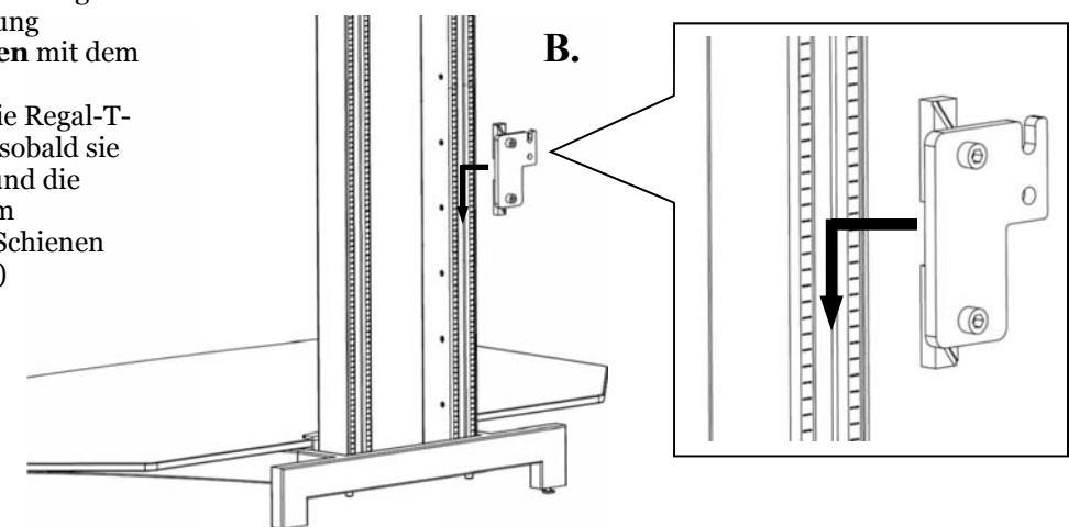
**HINWEIS:** Es muss sichergestellt werden, dass beim Anbringen der **Regalhalterung** die Kerbe nach oben und außen weist.
