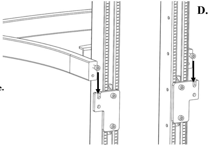
E. Ajuste el **tornillo del estante** superior, luego inserte y ajuste otro **tornillo del estante** en el agujero inferior.
