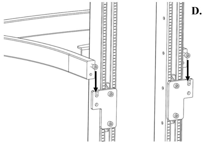
E. Die obere **Regalschraube** festziehen und eine weitere **Regalschraube** in die untere Bohrung einführen und festziehen.
