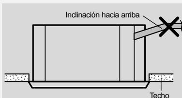
Si es necesario aumentar la altura del tubo de desagüe, instale el tubo de desagüe rectamente dentro de 300 mm del puerto flexible de la manguera. Si se levanta más alto que 550mm, puede haber escapes del agua.
