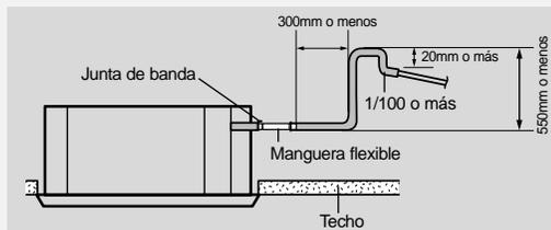
No aplique fuerza a la tubería sobre el lado de la unidad al conectar la manguera de drenaje. La manguera no debe estar permitido para colgarse sueltamente de su conexión a la unidad. Aprete la manguera a una pared, marco u otro soporte lo más cerca a la unidad posible.
