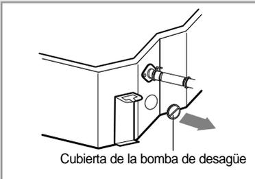
Cubierta de la bomba de desagüe
