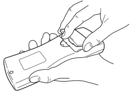
**2** Instale dos pilas tamaño AA, asegurándose de que la polaridad de las pilas coincida con los símbolos impresos en el interior del control remoto.
