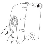
Montez le réservoir verticalement dans un endroit qui permet un dégagement sur le dessous du réservoir pour le drainage au besoin. NE PAS trop serrer les vis.
