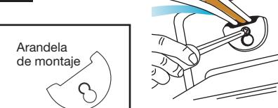
La arandela metálica con forma de media luna debe soportar todos los tubos que descienden.
