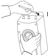
Le réservoir doit être monté de niveau pour
