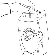
El tanque debe montarse nivelado para asegurar su funcionamiento correcto.
