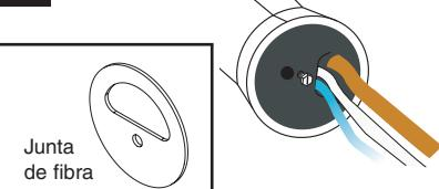
Asegúrese de usar una junta de fibra para obtener un sellado correcto.
