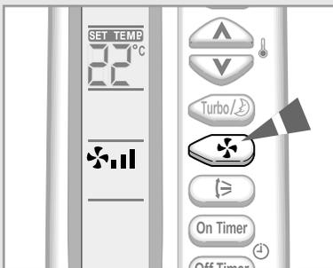
4 Seleccionar la velocidad del ventilador presionando el botón
