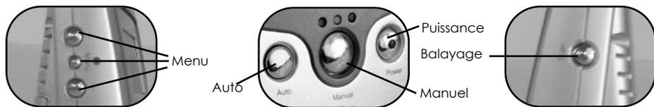
1. **BOUTON DE PUISSANCE** : ce bouton vous permet de tourner le moniteur "Marche/Arrêt" en appuyant sur simplement le bouton de PUISSANCE. La LED intégrée du bouton de puissance peut clignoter de temps en temps indiquant une basse batterie quand des batteries sont utilisées.
