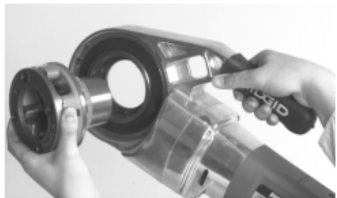
Figure 3 – Installation des têtes de filière type 11-R
