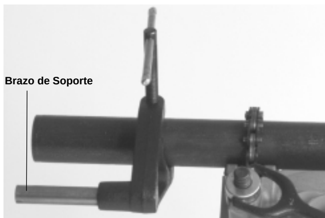
Figura 4 – Empleo del Brazo de Soporte No. 691 cuando se rosca un tubo de \frac{3}{4} pulgada o mayor
