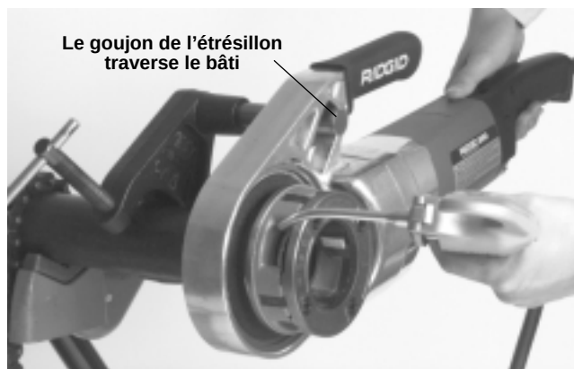
Figure 7 – Application d'huile en cours de filetage
