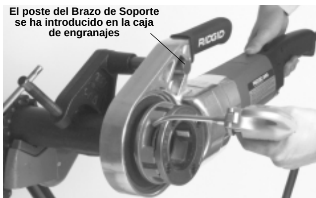
Figura 7 – Aplicación de aceite mientras se rosca
