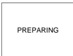
Mientras la cinta esté alineándose, es posible que a veces el papel de impresión se inserte y expulse por los lados izquierdo y derecho del cuerpo sin que se desactive la pantalla de cristal líquido aunque la lámpara POWER esté encendida.
