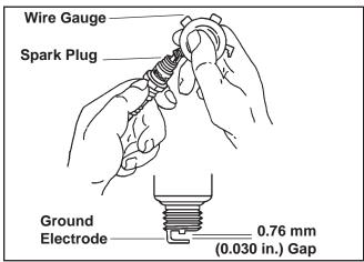
Figure 14. Servicing Spark Plug.
