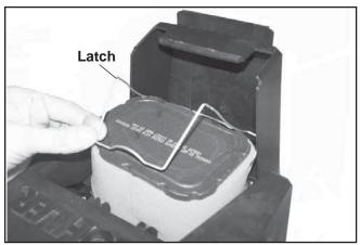
Figure 13. Unhooking Latch (Courage PRO).
