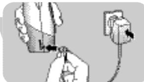
2 Koble strømadapteren (AC) (B-3) til et vegguttak.
