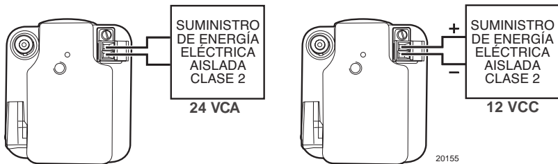
Figura 4. Conexiones de suministro de energía
